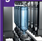
Air chaud soufflé à l'intérieur de la bouteille pour l'étirer et lui donner sa forme finale.
