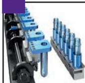
Refroidissement de la préforme et stabilisation de la température
